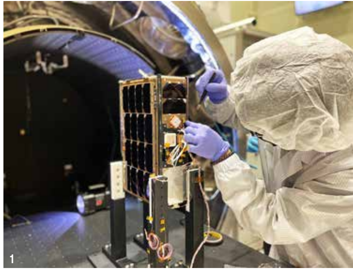
1 조선대 연구팀이 개발한 큐브위성 'STEP CUBE LAB-II' 및 큐브위성 열진공 시험 2 큐브위성을 개발한 조선대 연구팀
